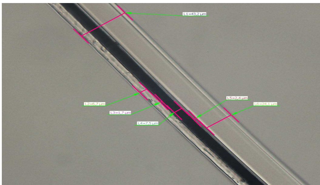
Obrázek 17: Měření tloušťky stěn na optickém mikroskopu
