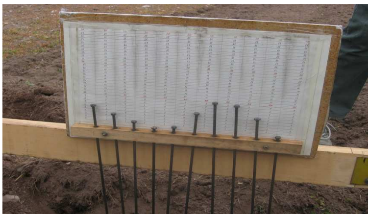
obr. č. 28 měření hloubky zpracované půdy pomocí měřících tyčí
