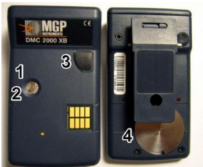
Obr. 2: Elektronický osobní dozimetr DMC 2000 XB (1 – střed detektoru, 2 – vstupní okénko pro detekci záření, 3 – funkční tlačítko, 4 – kryt baterie).
