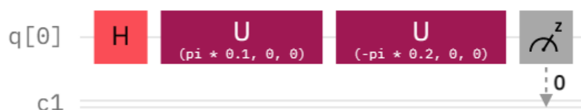
Obrázek 4: Porovnání dvou hodnot pomocí brány U3
