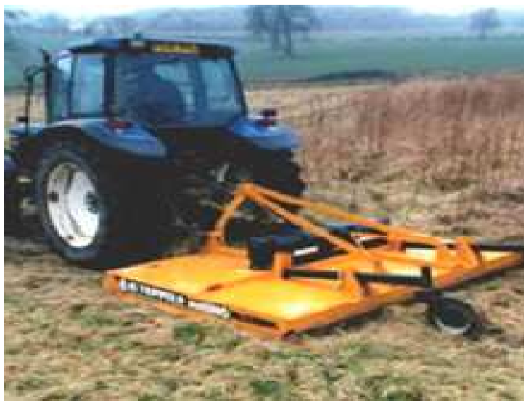
Obrázek 13 : Rotační mulčovač McConnel Topper 9
