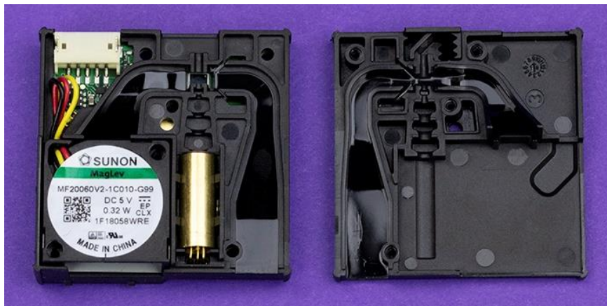
Obrázek 36: Rozložený senzor prachových částic Sensirion SPS30 [43]
