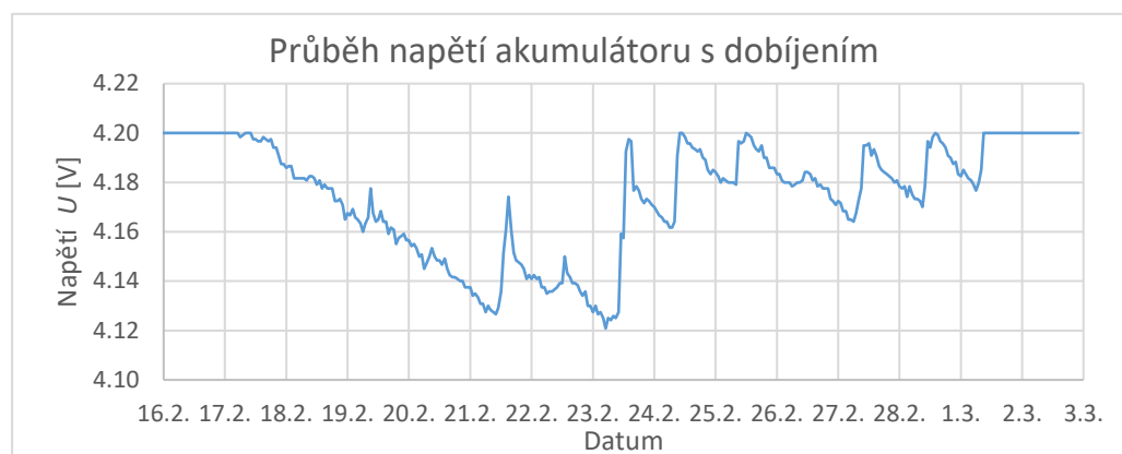
Graf 2: Průběh napětí akumulátoru s dobíjením pomocí instalovaného FV panelu
