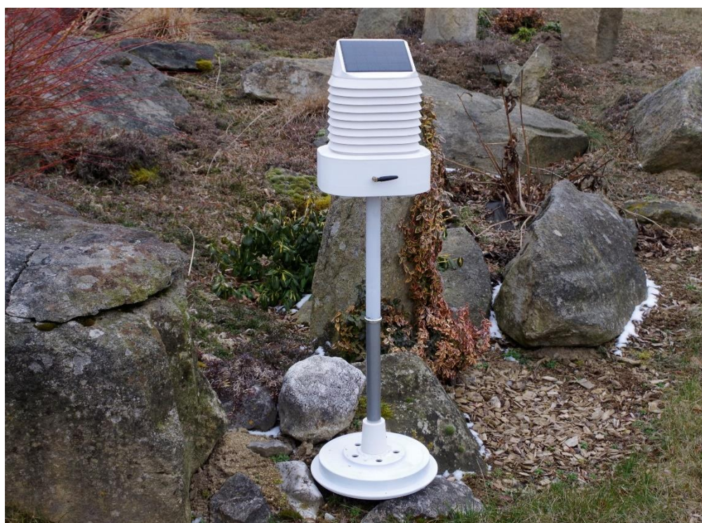
Obrázek 57: Kompletní zhotovená mobilní meteostanice
