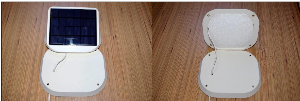
Obrázek 53: Instalace FV panelu a tepelná izolace střechy meteostanice
