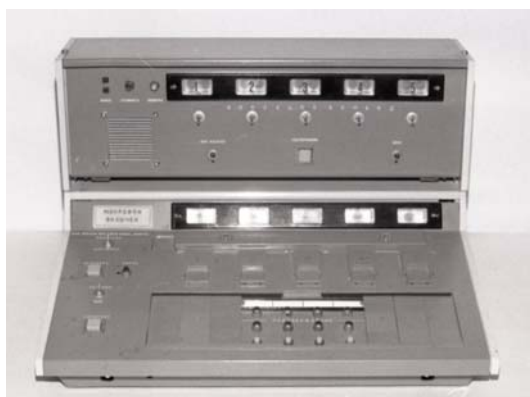
Obr.č.35- ovládání sirén P160 (tablo a pult) Obr.č.36 - Ovládání sirén P160 (linkový přenašeč)
