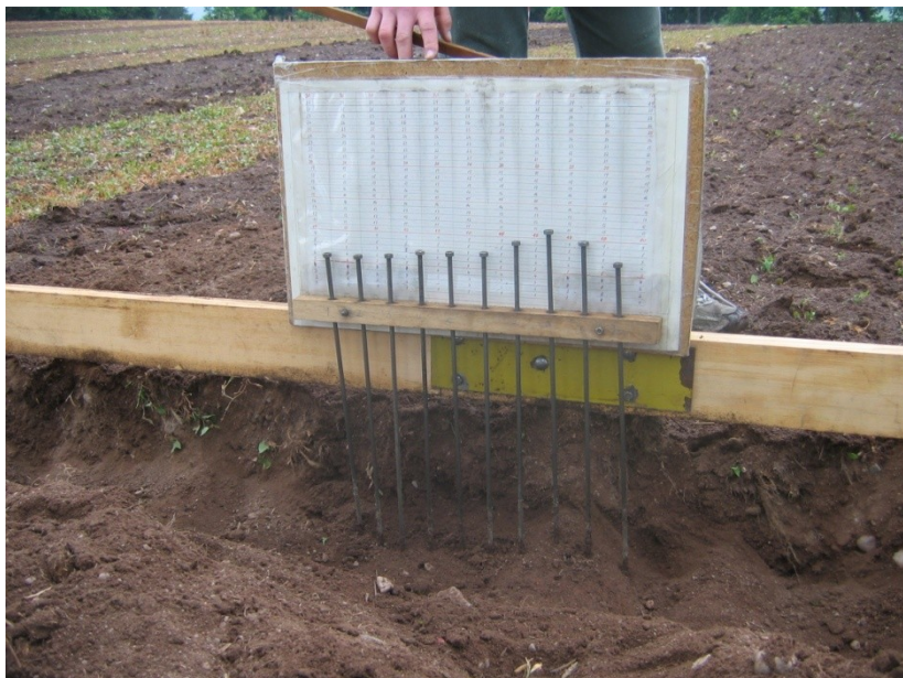
Obr.4 měření pomocí vodorovné latě [9]
