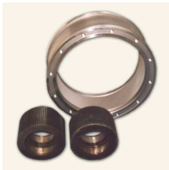
Obrázek 6.9: Matrice a rolly (STOZA s.r.o.)
