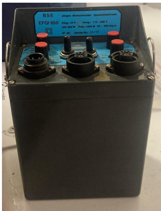
Obr. 8: Elektrický bateriový agregát EFGI 650 od německého výrobce (foto: Petráňová, 2023)
