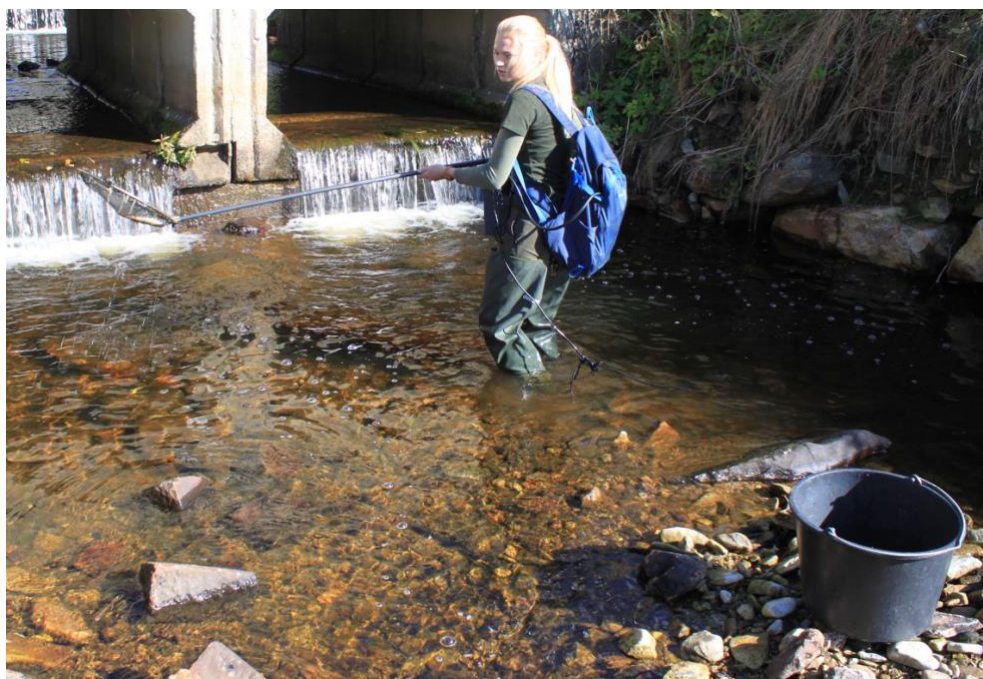
Obr. 9: Průběh odlovu ryb elektrickým bateriovým agregátem (foto: Dvořák, 2021)
