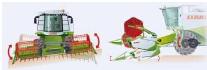
Obrázek 6 - Příčné a podélné kopírování žacího ústrojí
