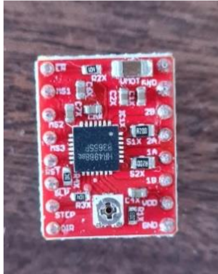
Obrázek 20) driver krokového motoru A4988 [autor]
