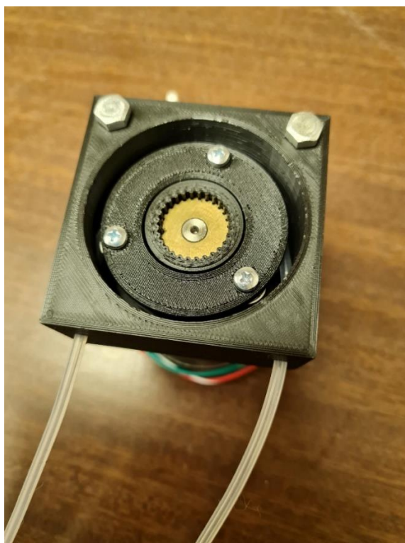
Obrázek 22) zhotovená peristaltická pumpa [autor]
