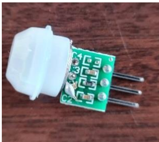
Obrázek 17) Pir senzor AM312 [autor]
