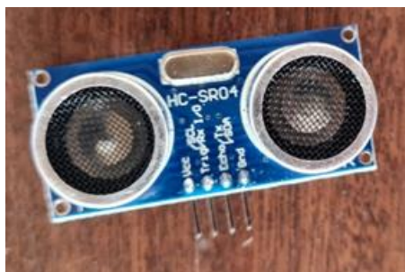
Obrázek 13) Senzor vzdálenosti [autor]
