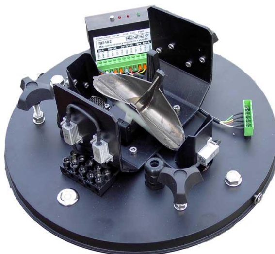
Obrázek 15) člunkový srážkoměr [převzato upraveno 44]
