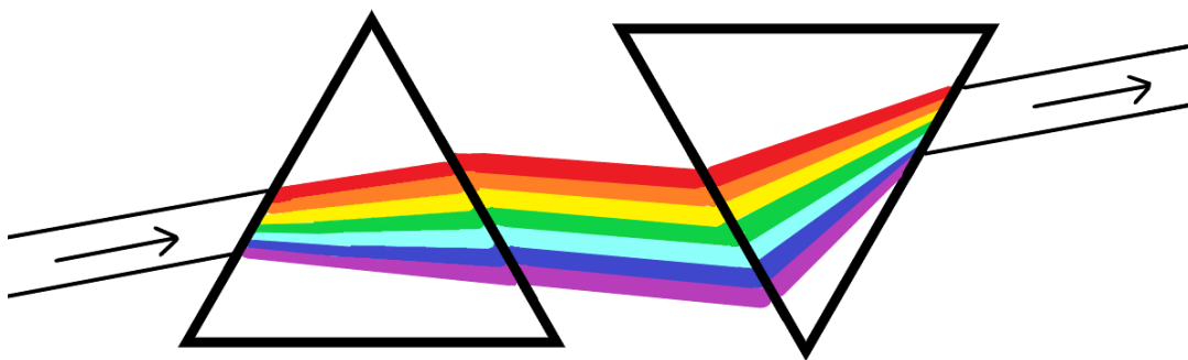
Obr. 6: Disperze bílého světla na hranolu a následné složení barevných složek (zdroj: vlastní zpracování).
