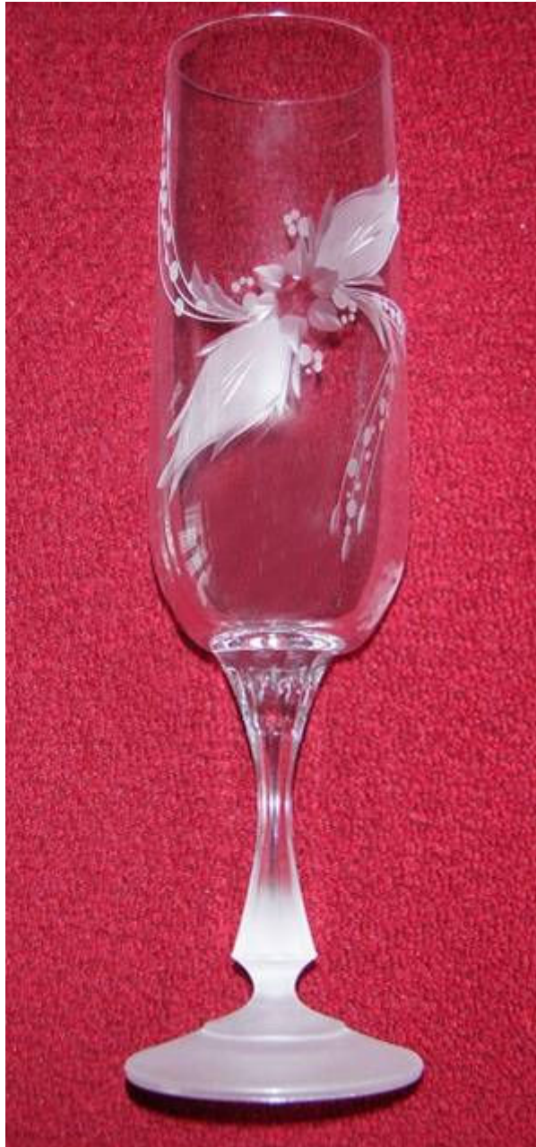
Abb. 25: Sektglas durch Sandstrahlen dekoriert (J.Jirman)
