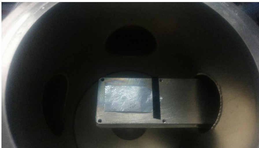
Obrázek 17: Vzorek umístěný na posuvném stolku
