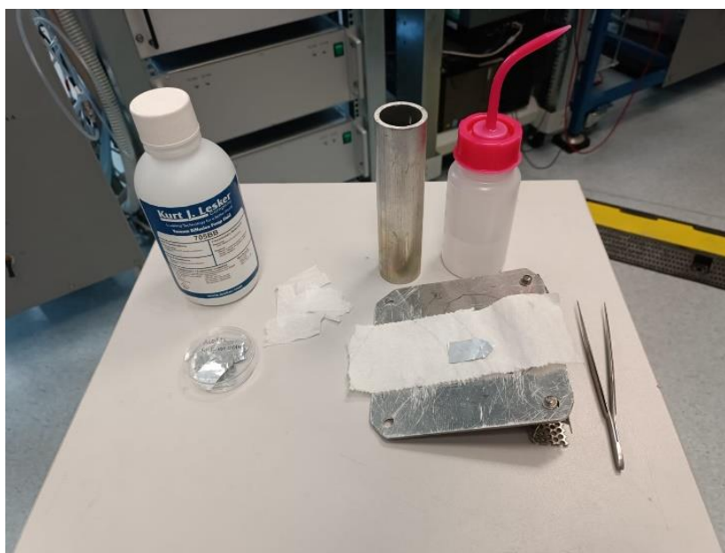
Obrázek 16: Systém aplikace nečistot (nakloněná rovina, válcové závaží, substráty, buničina, špinidlo)
