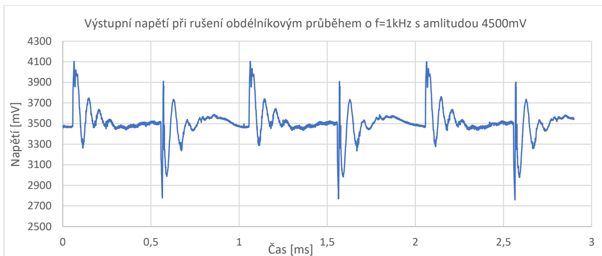
Graf 25: Výstupní napětí při rušení pomocí obdélníkového signálu o amplitudě 4500\text{mV}
