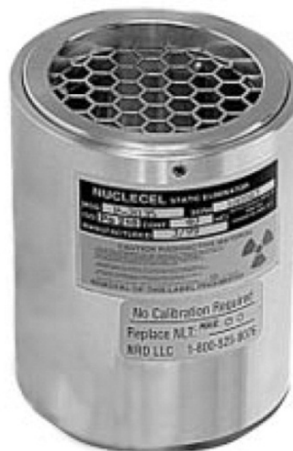
Obrázek č. 9. Náplň do antistatického „rozprašovače“ o aktivitě 1480 MBq.
