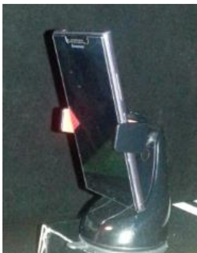
Obr. č. 39 Měření intenzity osvětlení v závislosti na úhlu natočení ke světelnému zdroji
