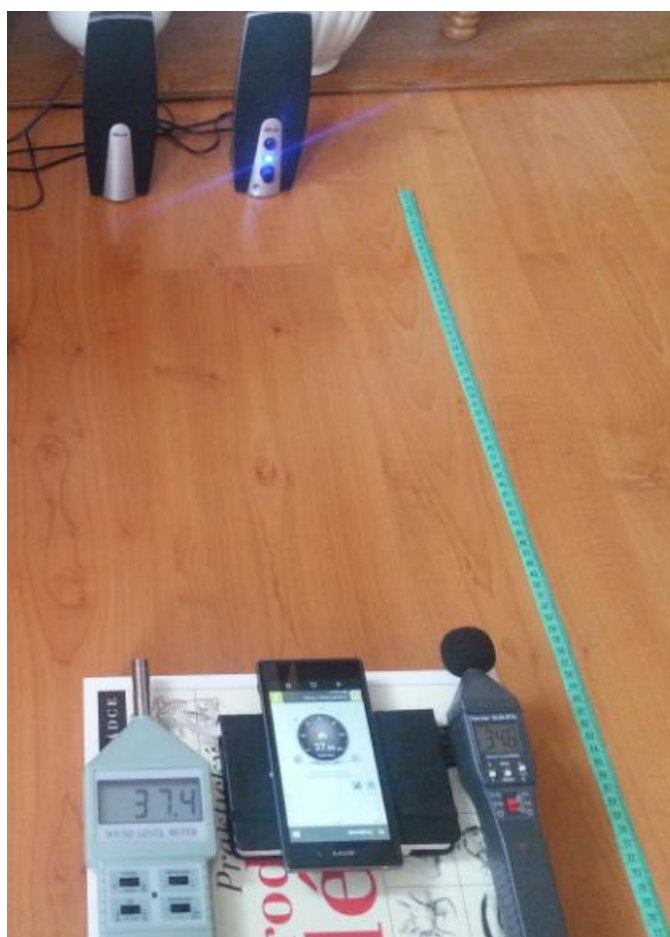
Obr. č. 45 Měření intenzity zvuku v závislosti na vzdálenosti od zdroje zvuku
