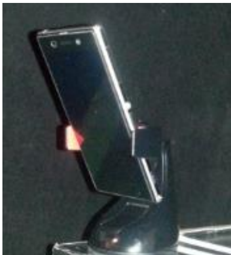
Obr. č. 35 Měření intenzity osvětlení v závislosti na úhlu natočení ke světelnému zdroji
