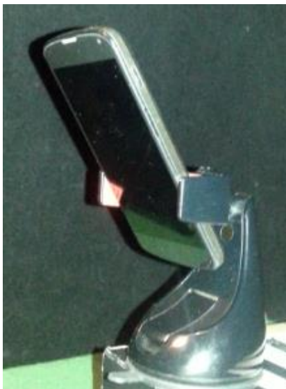
Obr. č. 37 Měření intenzity osvětlení v závislosti na úhlu natočení ke světelnému zdroji
