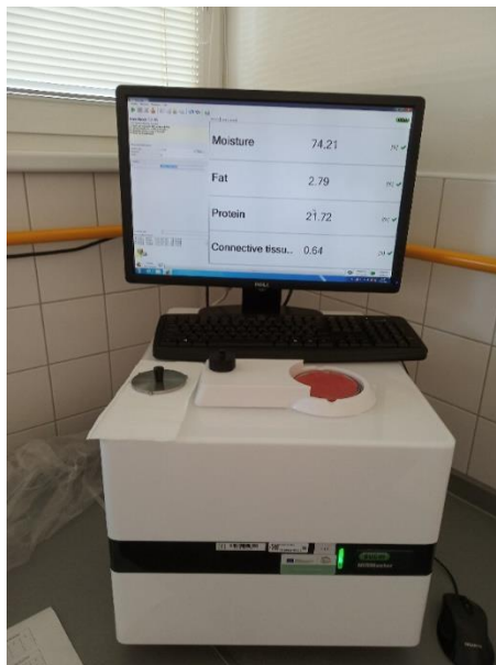
Obrázek 3.8 Měření složení na přístroji NIR Master
