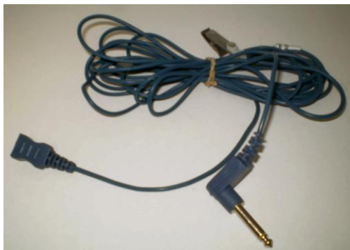
Zakončení na měření jádrové TT, foto: vlastní
