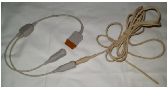
Kabel se zakončením na měření povrchové TT, foto: vlastní
