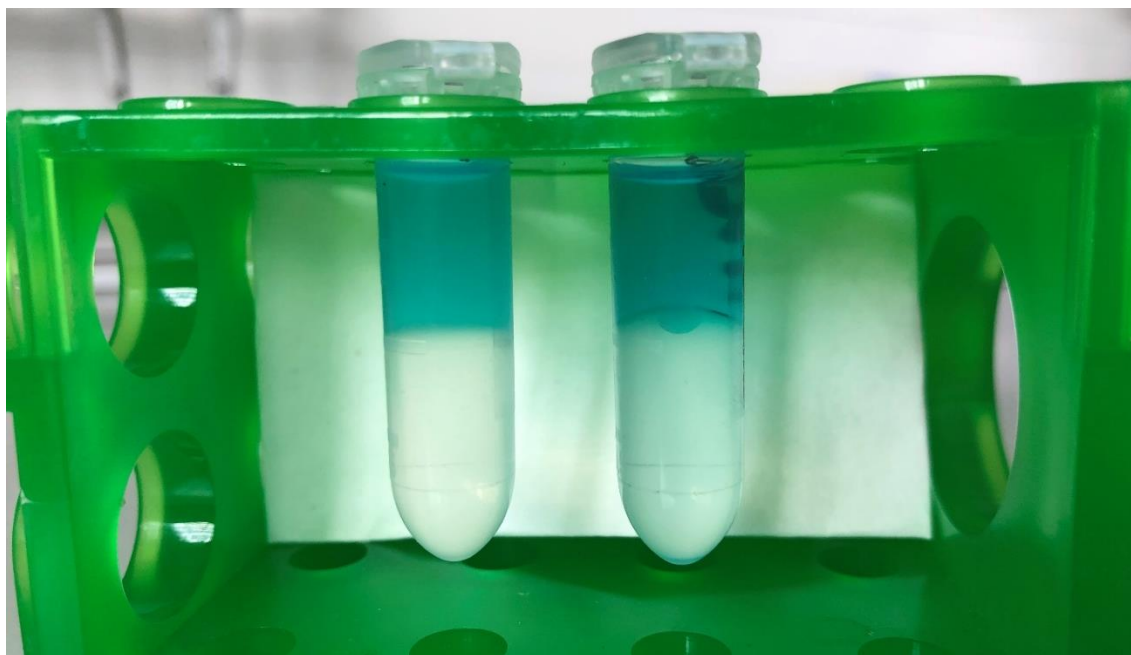
Obr. 4.9: Hexylester (vlevo) a hexylester s DCM (vpravo) po ukončení esterifikace a oddělení fází.
