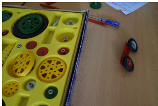
Obr. 73 Připevnění kol ke konstrukci.
