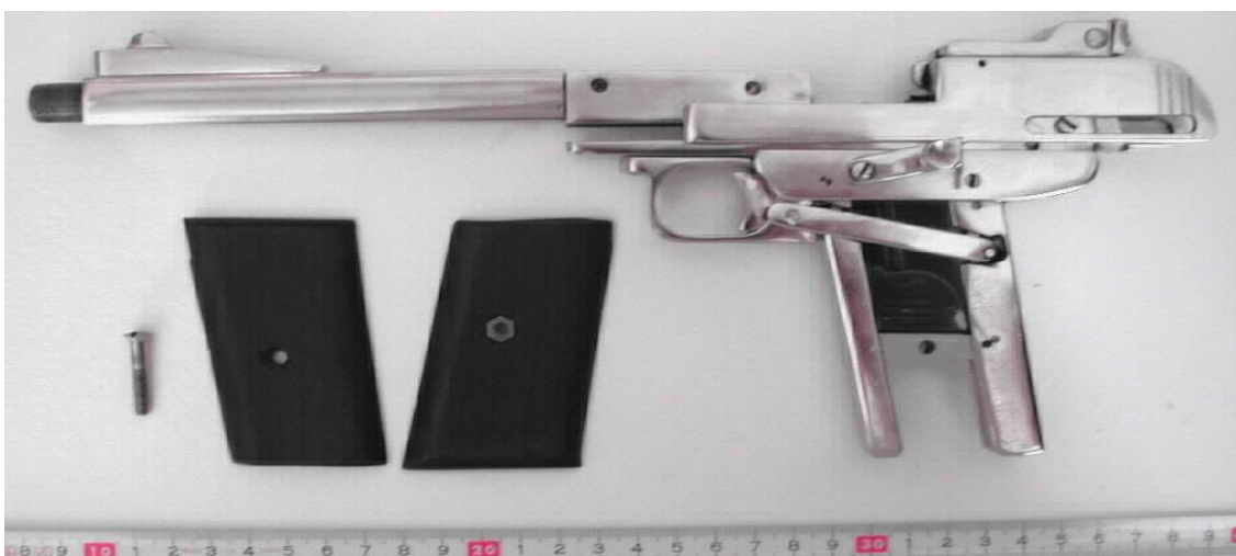
Pohled na zbraň s otevřeným závěrem a sejmutými střenkami.
