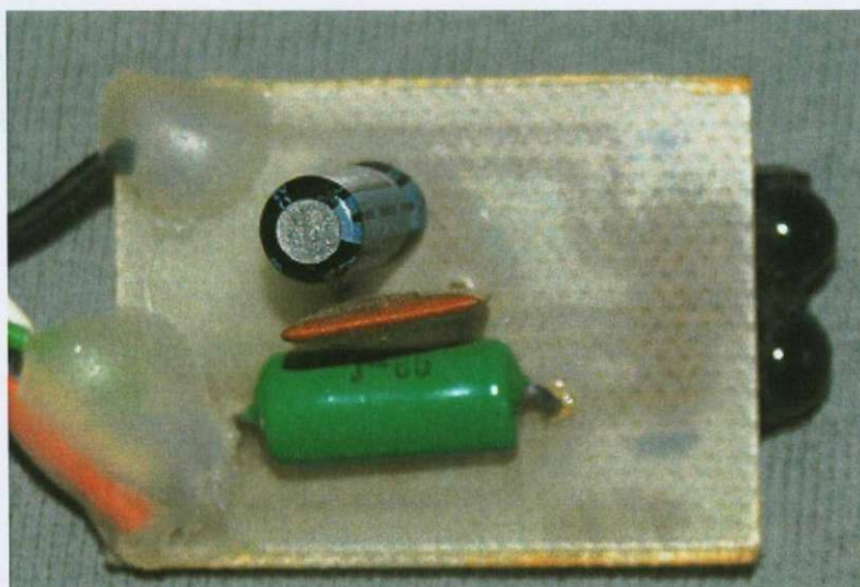
Pohled na umístění součástek na modulu IrDA s HSDL 1001
