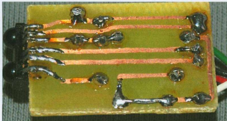
Pohled na modul IrDA ze strany tištěného spoje s obvodem TFDU 4100
