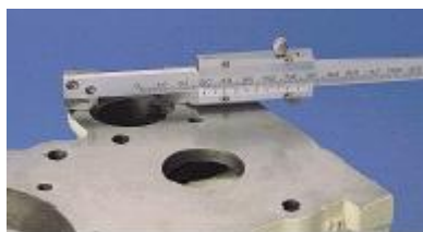
Obrázek 48: Příklad použití měřítka na vnitřní příčné drážky
