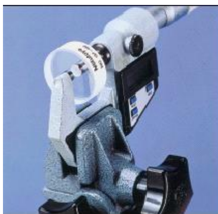
Obrázek 66: Použití interferenčních skel
