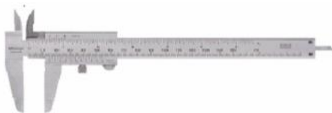
Obrázek 25: Posuvné měřítko s aretačním šroubkem
