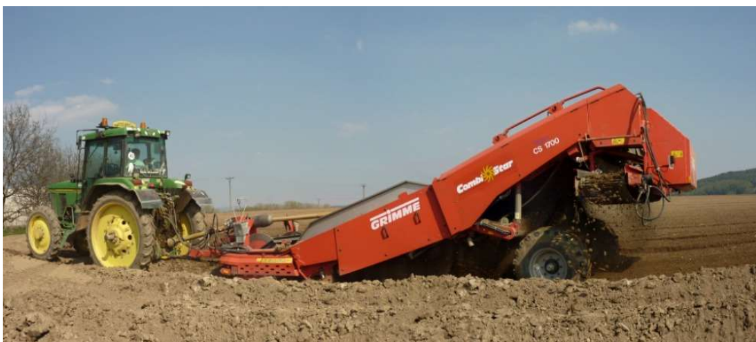
Obr. č. 21 - Separace kamene před výsadbou brambor – VOD Zdislavice
