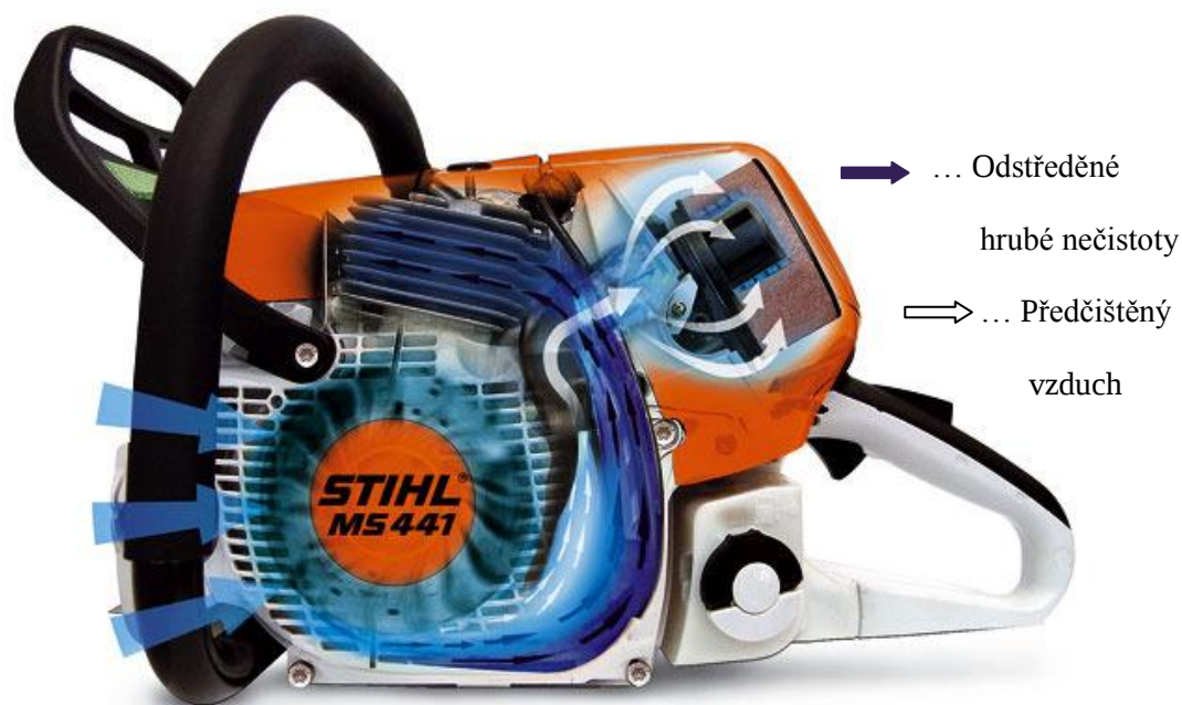
Obr. 25 Princip funkce odstředivého předčištění nasávaného vzduchu (Stihl) [8]
