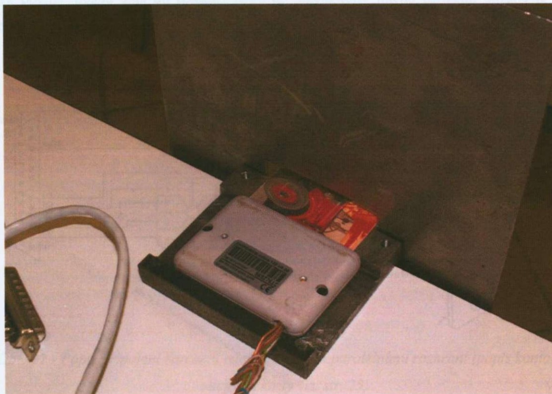
Obr.11 - Otevřené pouzdro z konstrukční oceli – uvnitř samotná čtečka
