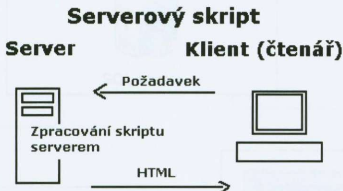
Obr. 15 – Komunikace PHP serveru s klientem
