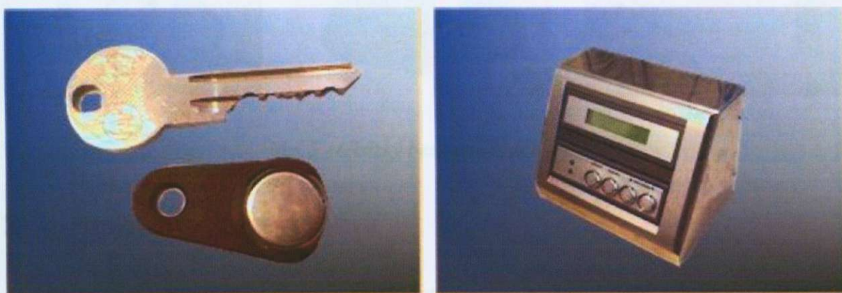
Obr. 4 - Kontaktní čip Dallas a čtečka docházkového systému iButton
