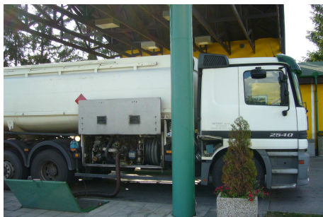
Obr. 22 a Obr. 23: Tříkomorová cisterna vybavena jedním stáčecím mechanismem
