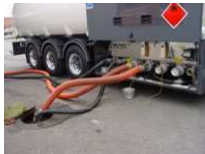
Obr. 21: Stáčení automobilové cisterny
