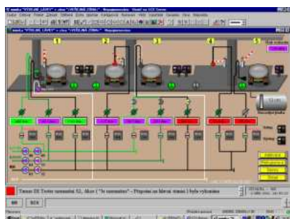
Obr. 17 a Obr. 18: Software dohlížející na bezpečné plnění cisteren
