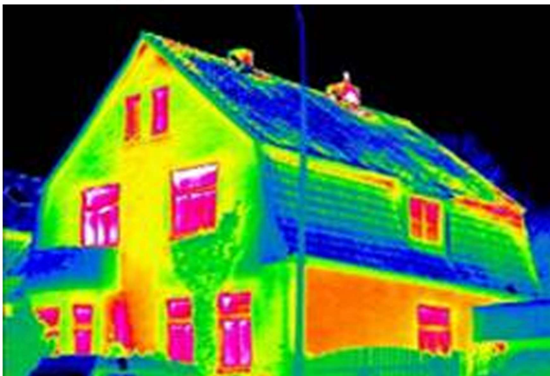
Obrázek 2: Termografický snímek domu
