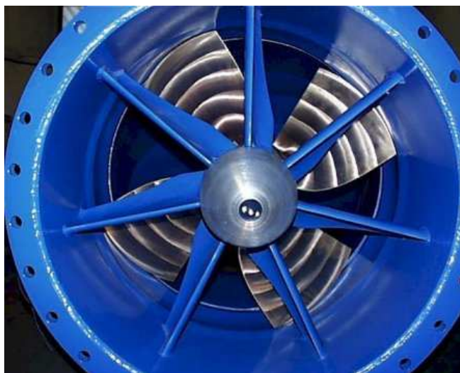
Obr. 7.3.4.a Turbína Semi – Kaplan [31].
