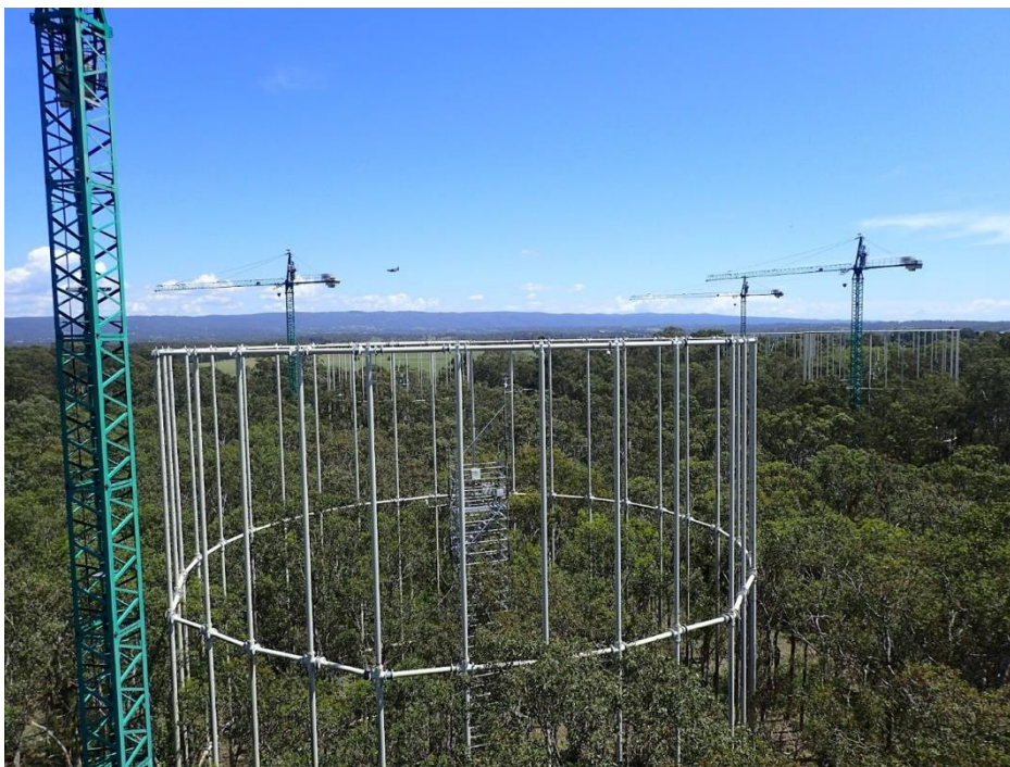
Obrázek 4: Korunové jeřáby a prstencové aplikátory CO 2 na lokalitě EUCFace, Richmond, Austrálie, autor: Kateřina Sam.
