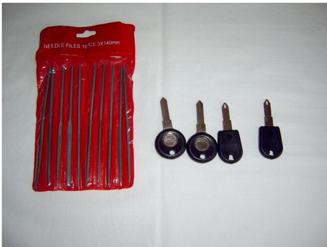
Obr. č. 25 – sada pilníků k vypilování klíčů
