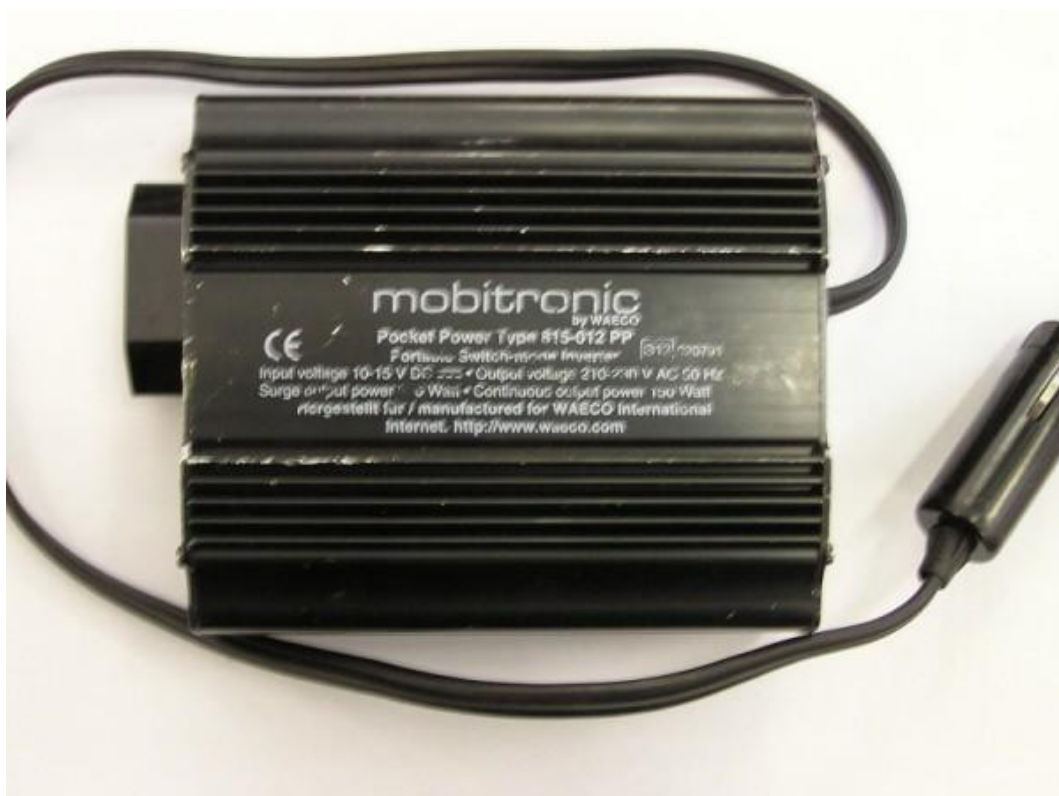
Obr. č. 20 - měnič napětí - používá se pro napájení notebooku v automobilu z 12 V na 220 V
