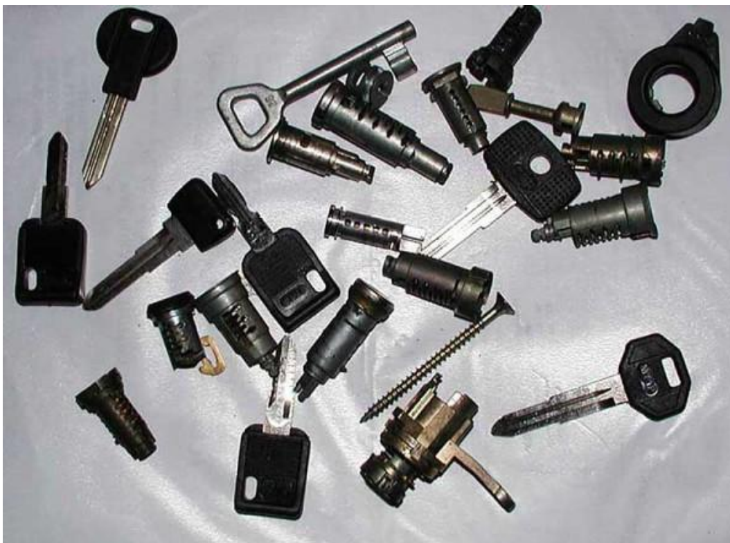
Obr. č. 22 - sady klíčů a zámkových vložek pro výměnu, snímač kódu klíče k IMO
