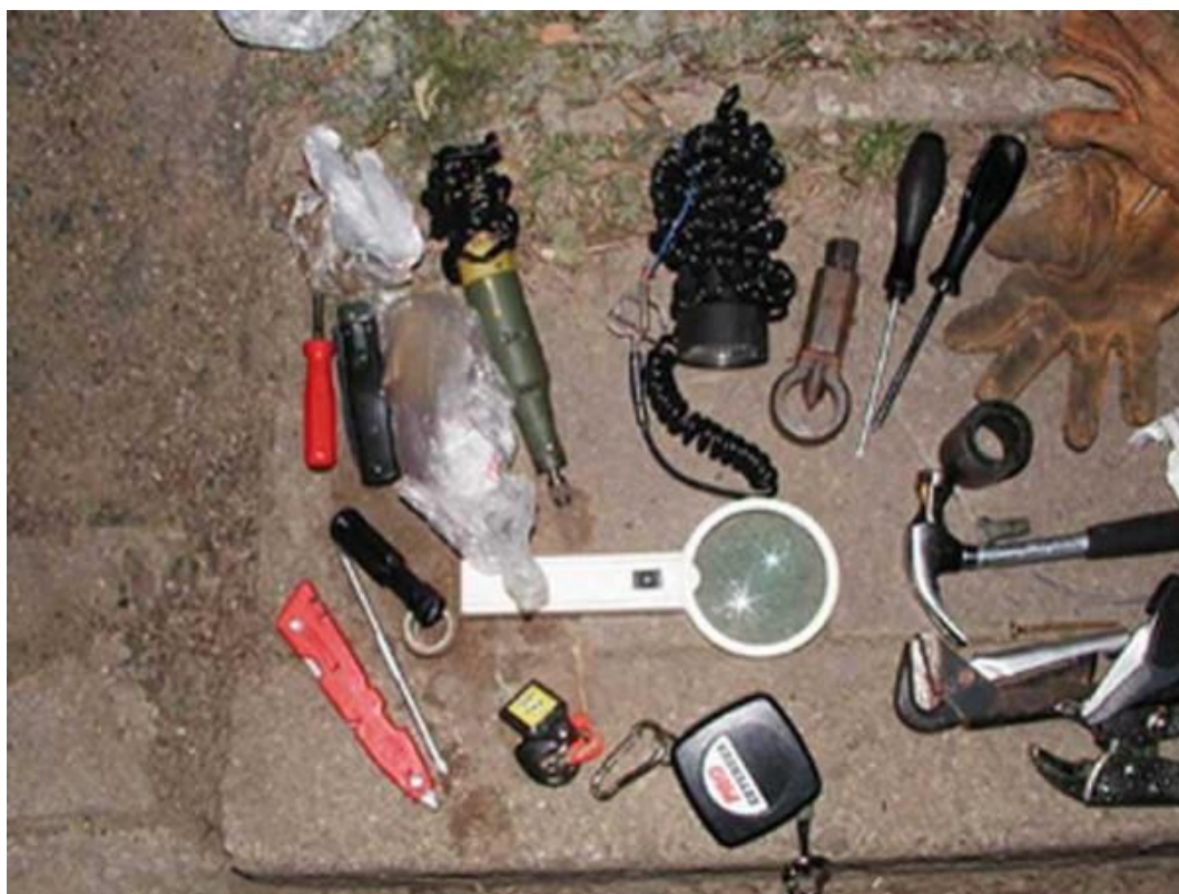
Obr. č. 39 – nalevo od šroubováků rozlamovák, trhák a uvolňovač v jednom
