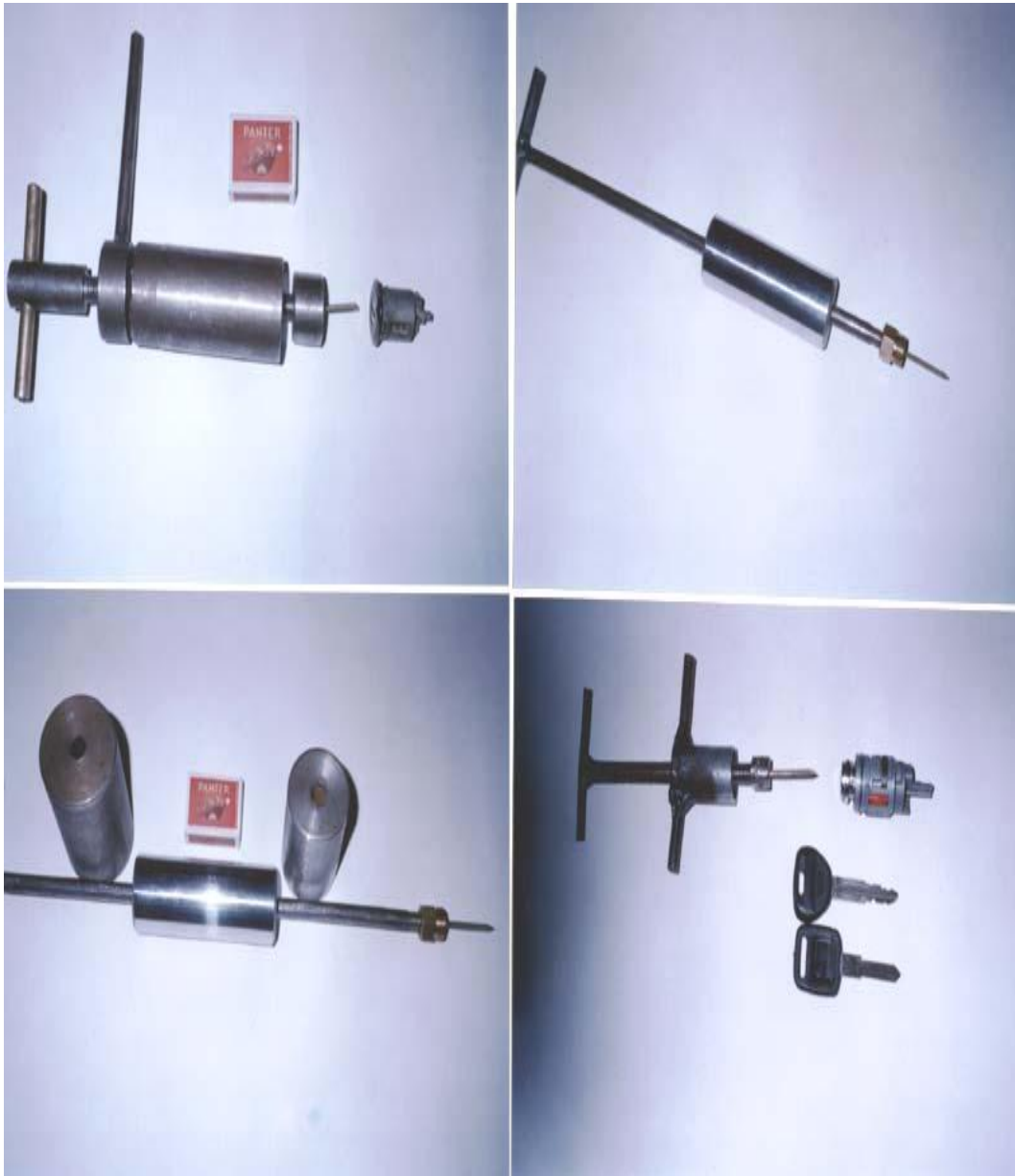
Obr. č. 11 – trháky vložky zámků
