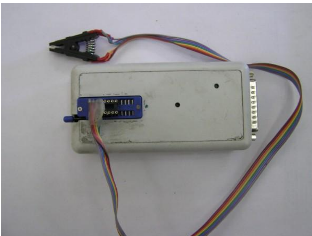
Obr. č. 41 - programátor - přenastavování čipů v klíči
