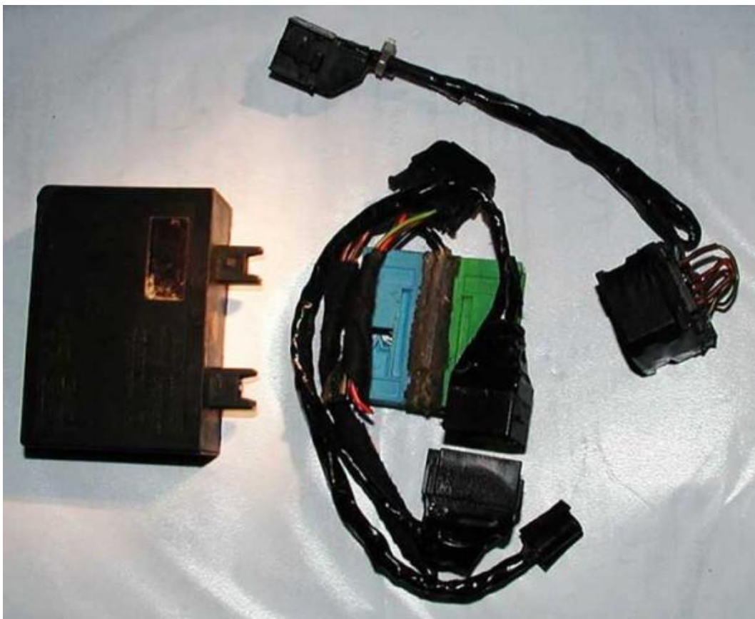
Obr. č. 32 - imobilizer, kabely pro VAG, kabely pro budíky
