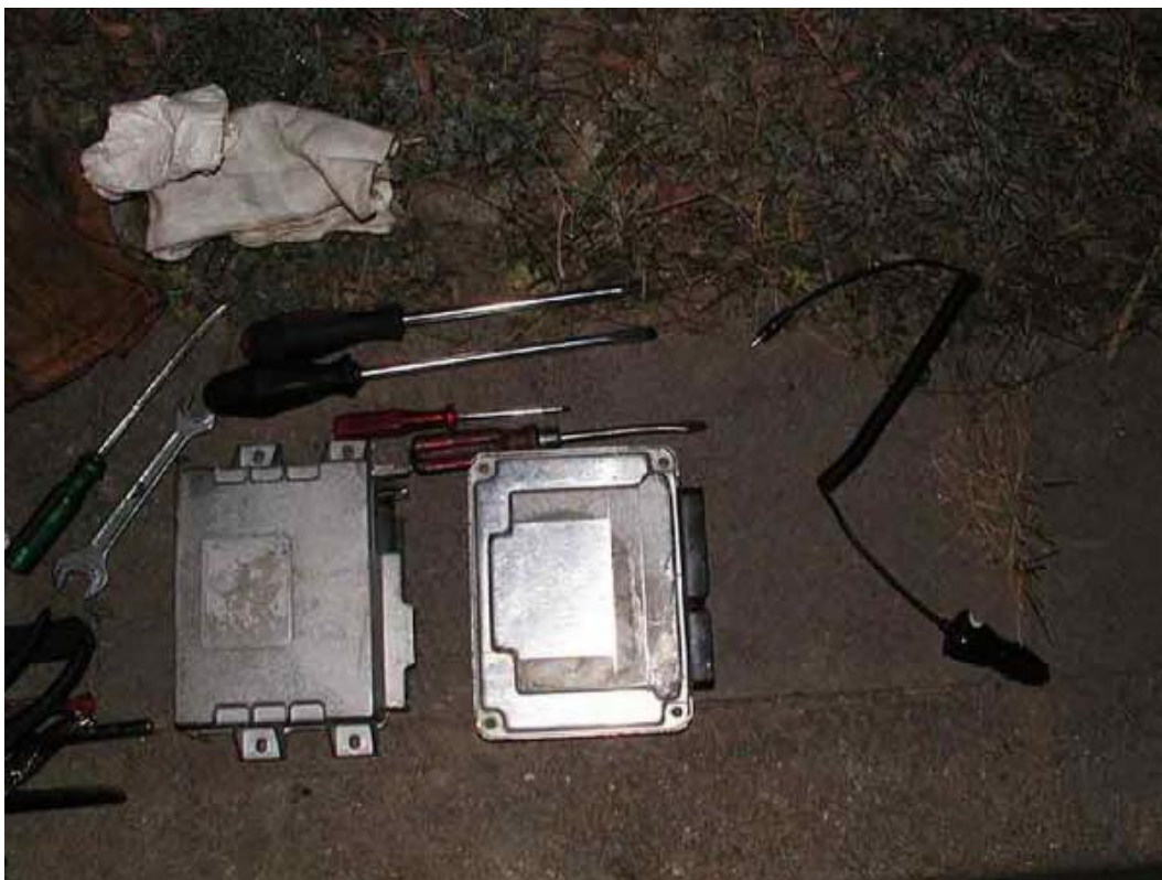
Obr. č. 40 - řídicí jednotky, nabíječka na mobil slouží též pro napájení frézky
