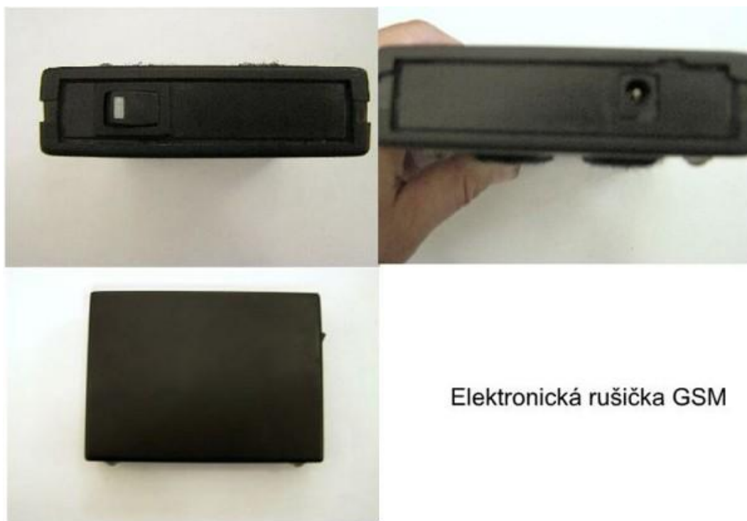
Obr. č. 42 - elektronická rušička GSM - slouží k rušení satelitního zabezpečení
