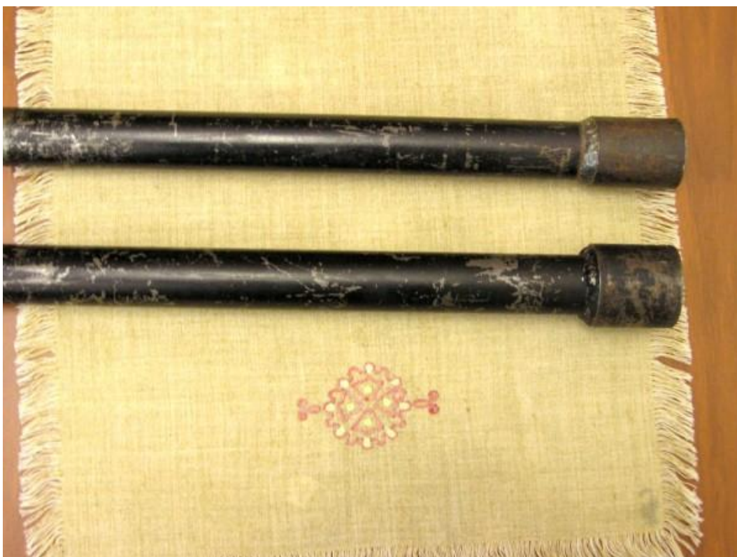
Obr. č. 2 – lámák pro rozlomení vložky konstrukt
