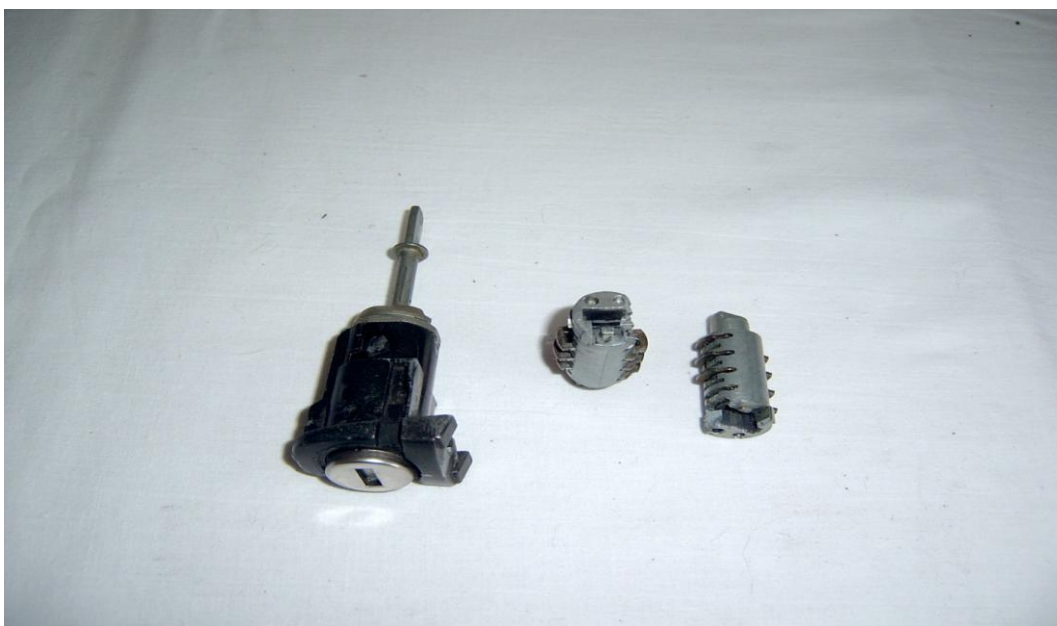
Obr. č. 24 – zámek Škoda Octavia + vložka zámku
