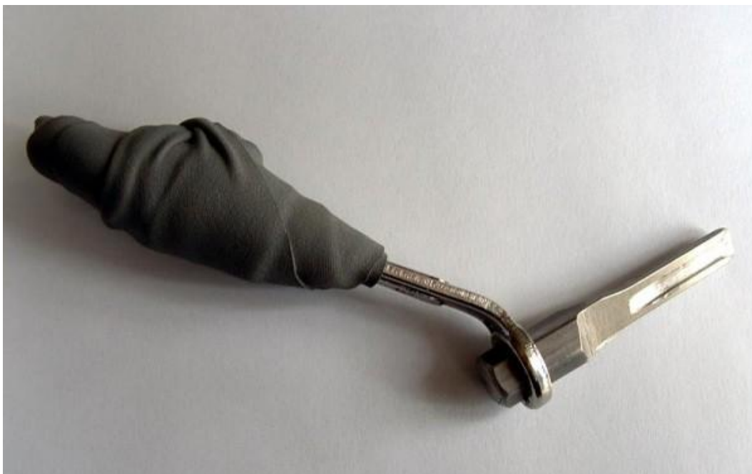
Obr. č.1 - Rozlamovák vložek, byl používán též k otevírání Octávií přes kufr
