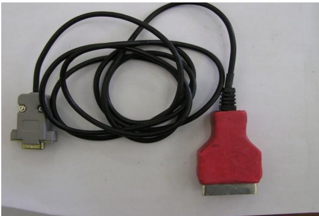
Obr. č. 18 – kabely - koncovky pro připojení VAG na servisní zásuvku
