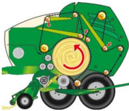
Obrázek 1.13 – Svinovací lis s variabilní komorou tvořenou příčkovými dopravníky Comprima (krone-agriculture.com, 2022)
