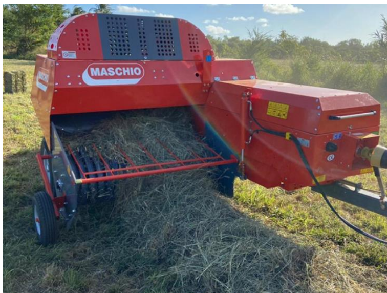
Obrázek 1.2 - Lis na malé hranolovité balíky PITAGORA (maschio.com, 2023)
