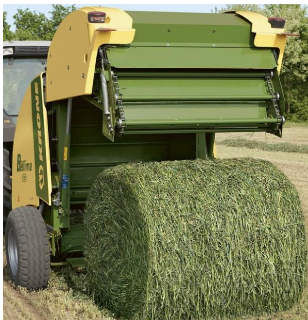
Obrázek 1.8 - Lis na válcovité balíky s příčkovým dopravníkem Belima (vobosystém.cz, 2022)
