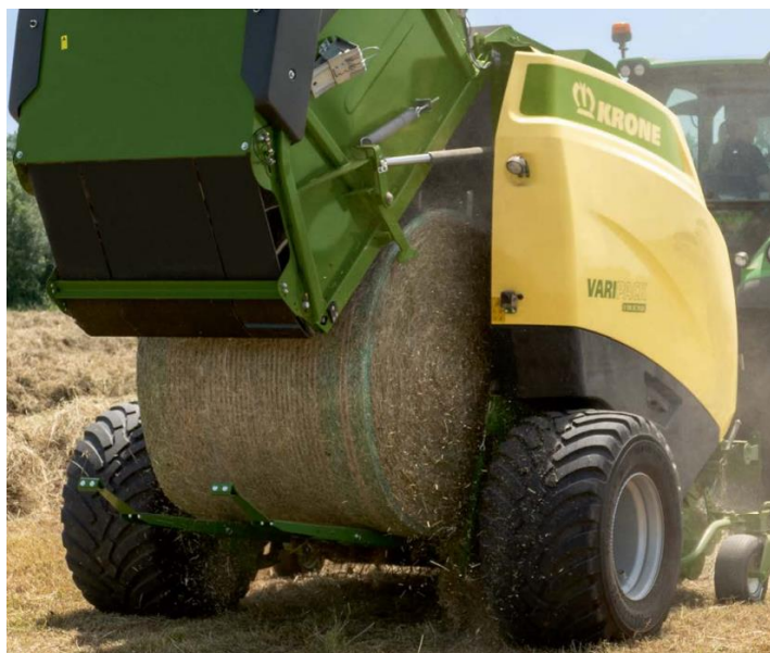
Obrázek 1.11 - Svinovací lis s variabilní komorou tvořenou profilovanými nekonečnými pásy VariPack (moreauvysocina.cz, 2022)
