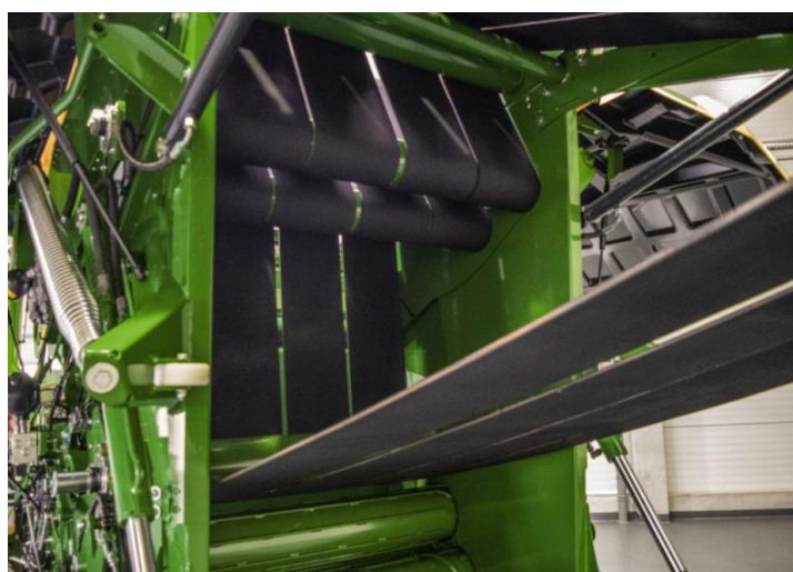
Obrázek 1.12 - Svinovací lis s variabilní komorou tvořenou profilovanými nekonečnými pásy VariPack (moreauvysocina.cz, 2022)
