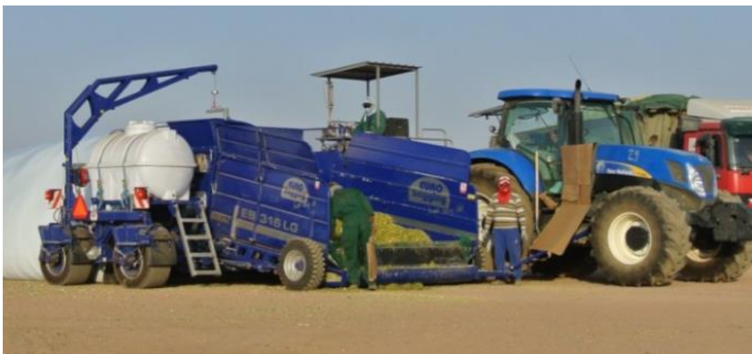
Obrázek 1.5 - Stacionární lis na vaky, rukávce silážní lis EB 316 LG (eurobagging.com, 2022)
