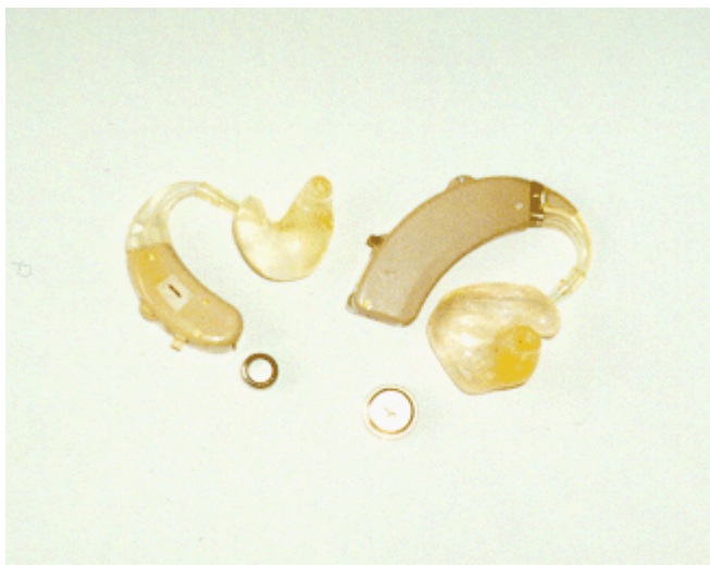
Foto č. 6: 2 typy závěsných sluchadel, včetně zdroje (1 akumulátor, 1 baterie) a individuálních tvarovek.
