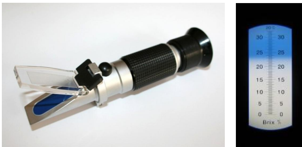
Obrázek 1. Optický refraktometr REF32-M R a stupnice k měření kvality mleziva
