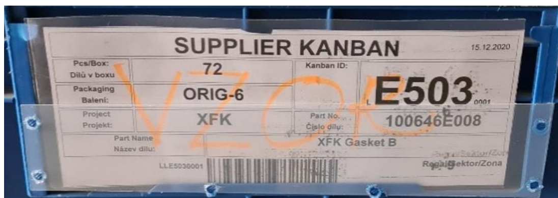
Obrázek 4.7: Vzor kanban kapsy se štítkem na krabici (TSE)
