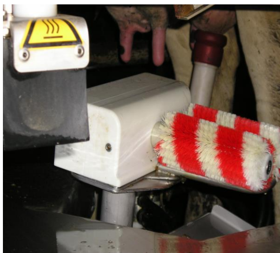
Obrázek 4: Manipulační systém provádí postupné nasazení strukových násadců
