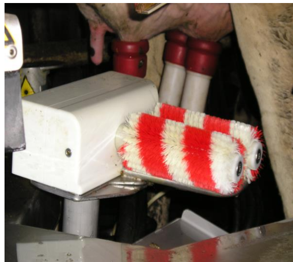
Obrázek 4: Manipulační systém provádí postupné nasazení strukových násadců
