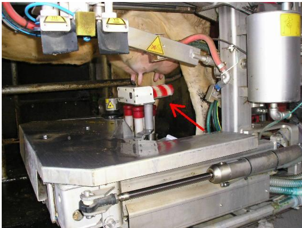
Obrázek 3: Rotační protiběžné válcové kartáčky očistí postupně všechny struky až k vemenu
