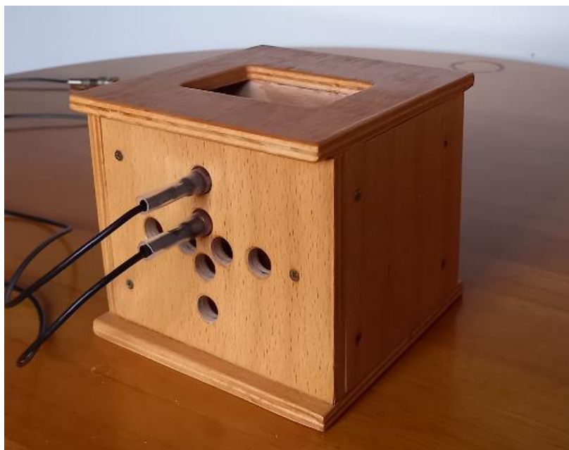
Obr. 21: Stojan pro měření Rossiho křivky
