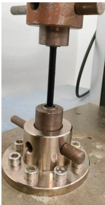
Obrázek 3.9: Upnutí vzorku do kleštin trhacího přístroje
