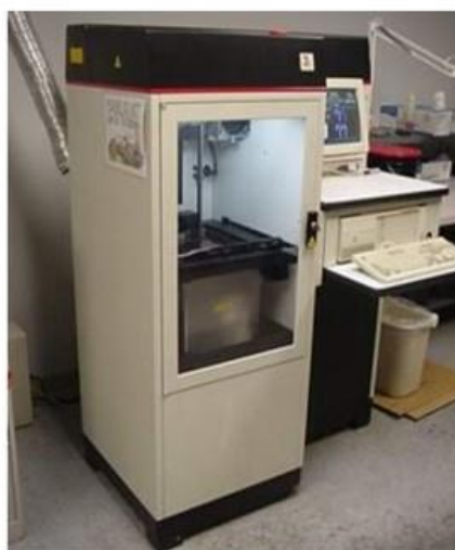
Obrázek 1.1: První SLA 3D tiskárna Apparatus (fs.cvut.cz, 2022)
