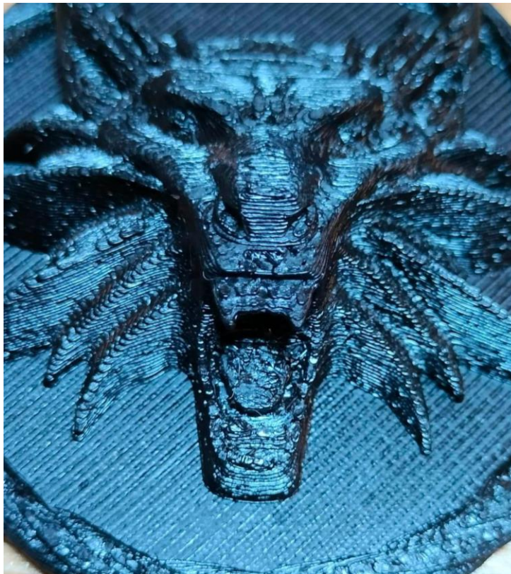
Obrázek 4.9: Kvalita úst a jednotlivých vrstev vzorku vytištěném na tiskárně Tevo Tarantula
