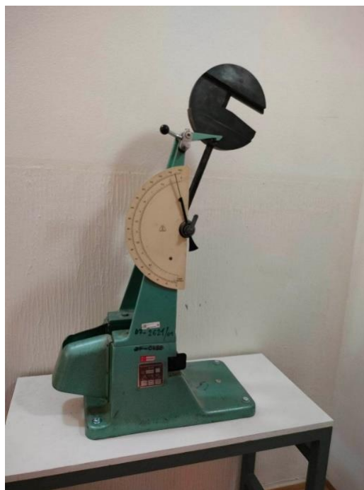
Obrázek 3.5: Sharpyho kyvadlové kladivo použité pro zkoušku vrubové houževnatosti
