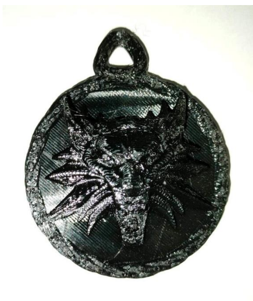
Obrázek 3.10: Vzorek použitý pro optickou zkoušku kvality povrchu
