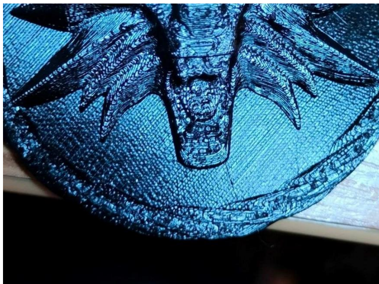
Obrázek 4.7: Povrch vzorku vytištěného na tiskárně PRUSA i3 MK3
