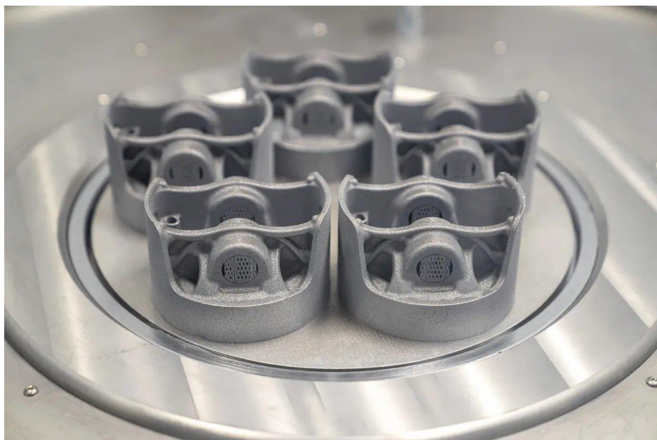
Obrázek 1.14: Písty pro Porsche 911 GT2 RS vytištěné na 3D tiskárně technologií SLM (auto-mania.cz, 2020)
