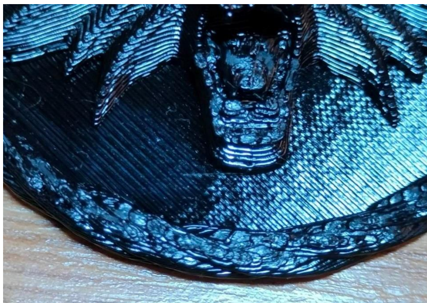
Obrázek 4.5: Povrch vzorku vytištěného na tiskárně Creality Ender-3 V2
