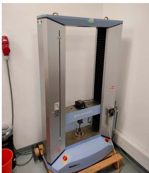
Obrázek 3.8: Univerzální trhačí přístroj použitý v této bakalářské práci
