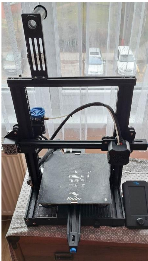
Obrázek 1.2: 3D tiskárna Creality Ender-3 V2
