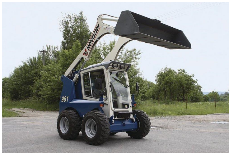
Obrázek 9: Radiální zdvih výložníku Novotný (Stavební-technika, 2012)
