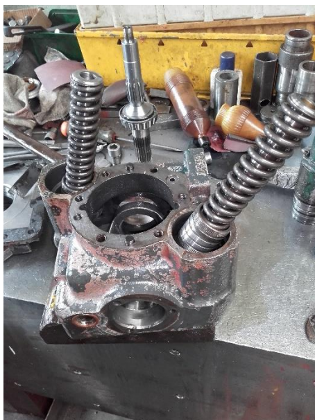
Obrázek 36: Skříně HG se servopísty
