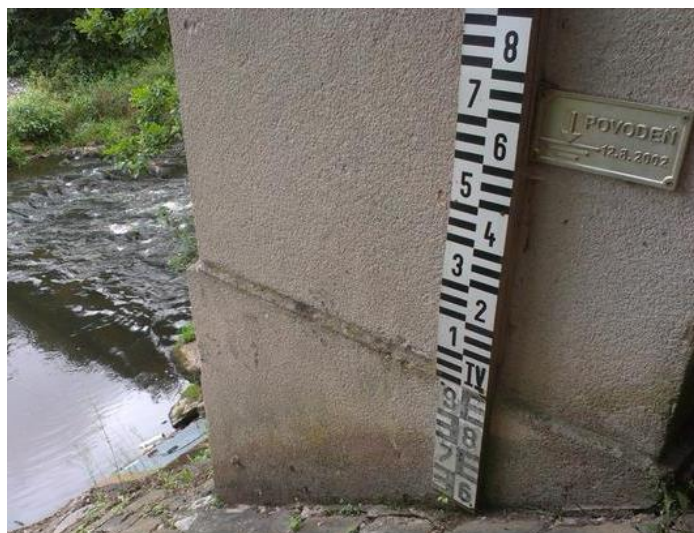
Obrázek 1.13: Vodočetná lať (d34-a.sdn.cz, 2022)
