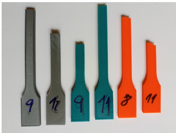
Obrázek 3.4: Vzorky konfigurace výplň po tahové zkoušce.
