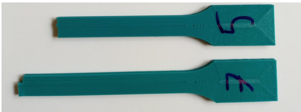
Obrázek 3.5: Vzorky konfigurace perimetr, materiál Aurapol po tahové zkoušce.
