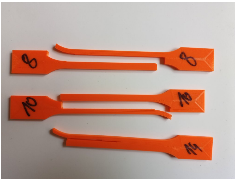
Obrázek 3.6: Vzorky konfigurace perimetr, materiál Prusa po tahové zkoušce.
