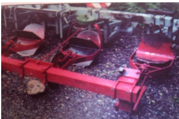
Obr. č. 11: Hrázkovač HN5-VD s otočným lopatkovým kolem (Hůla a kol., 2003).
