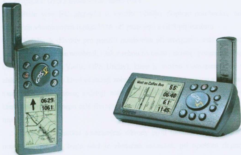
Obr. 3-Ukázka přístroje GPS V-disponuje 19MB paměti na mapy, je určen pro použití v autě, na motocyklu a v ruce. Obsahuje vestavěnou mapu celého světa s podrobnou mapou Evropy.
