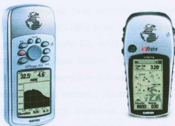
Obr. 2-Ukázka přístroje GPSMAP76S (univerzální přístroj vhodný pro navigaci ve vodě, na zemi i ve vzduchu) a Garmin eTrex Vista (nejluxusnější verze z řady přijímačů eTrex. Jedná se o kombinaci schopností verze Summit a Legend v jednom přístroji.
