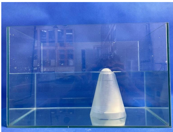
Obrázek 57: Přísátý zvon ke dnu akvária
