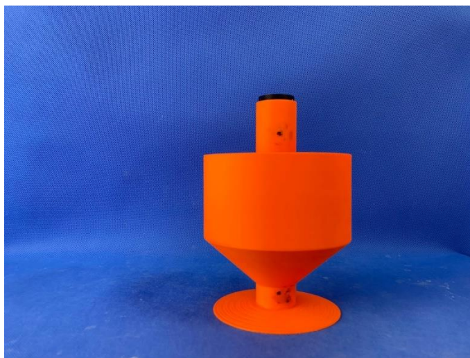
Obrázek 37: Hopeho přístroj vytištěný na 3D tiskárně
