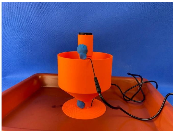
Obrázek 45: Hopeho přístroj vytištěný na 3D tiskárně s bodovými teploměry
