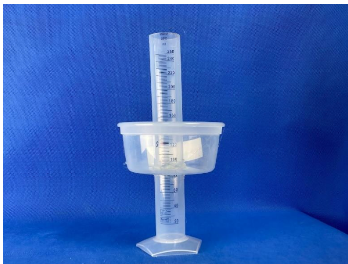
Obrázek 32: Hopeho přístroj z odměrného válce
