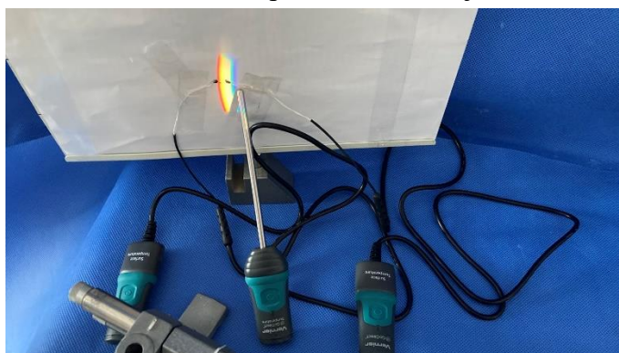
Obrázek 66: Bodové teploměry přilepené k papíru
