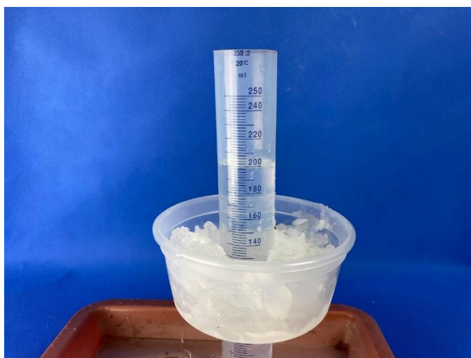
Obrázek 43: Hopeho přístroj s vodou a ledem
