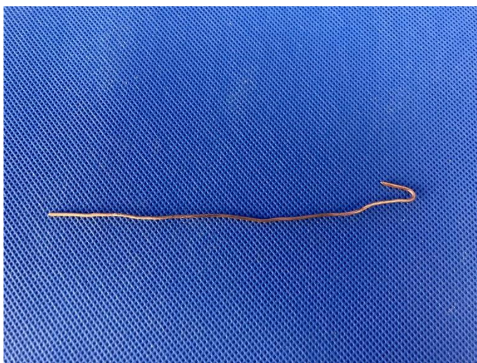
Obrázek 22: Kratší měděný vodič s upraveným koncem
