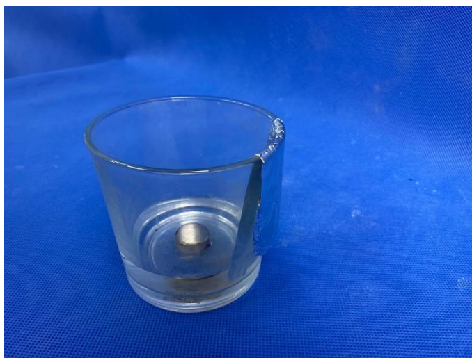
Obrázek 28: Nádoba s magnetem, alobalem a solným roztokem
