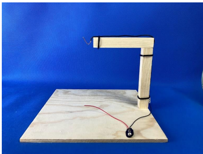
Obrázek 18: Vodič připevněný ke konstrukci s ohnutým koncem
