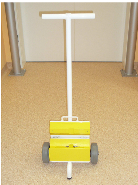
Obr.4. Olověný vozík k přepravě FDG z přípravy k pacientovi
