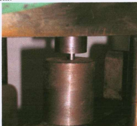
obr. 13 Zkušební vzorek upnutý mezi čelisti zkušebního stroje
