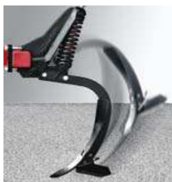
Obr. č. 6 Zdvih před překážkou
