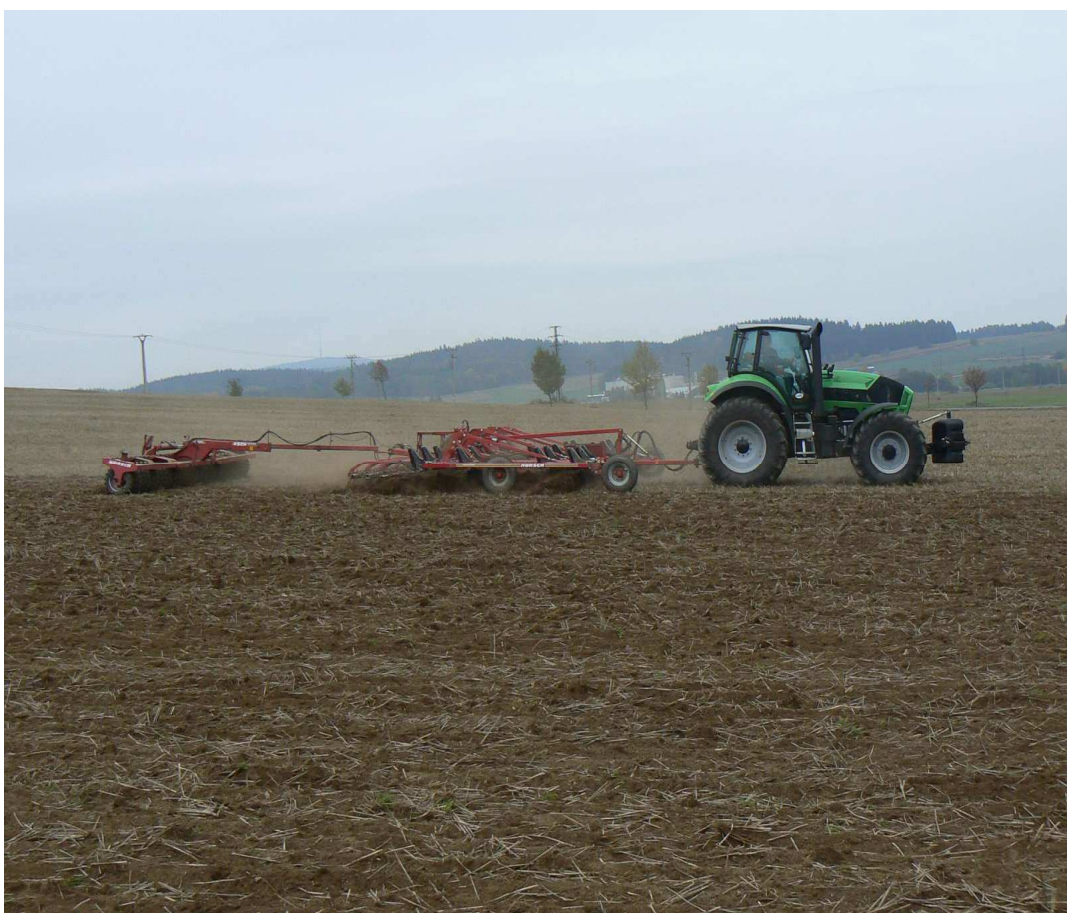
Obr. č. 25: Deutz Fahr X 720 v agregaci s podmítačem Horsch Terrano FG (foto Novák M. Stagra)
