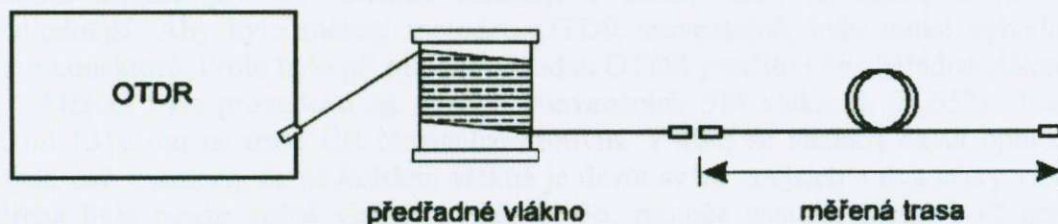
obr.4.6 Schéma zapojení OTDR [5]
