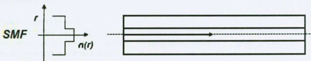
Obr. 2.6 Princip šíření světla v SM vlákne [6]
